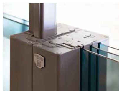
Innovativo paravento con pannelli in vetro a scorrimento verticale senza profili orizzontali. Il sistema brevettato di apertura pneumatico "Press and Open" consente di sollevare i pannelli ad altezze diverse con un piccolo gesto, per controllare areazione e comfort climatico in piena libertà. Disponibile con sistema di illuminazione led integrato.
